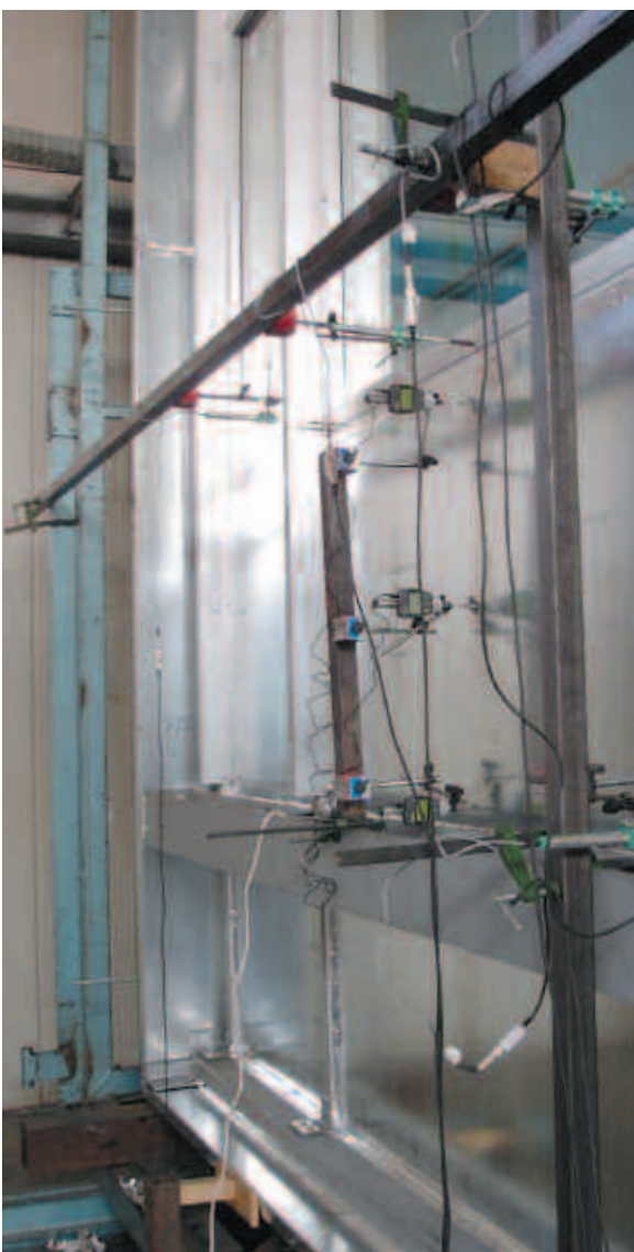
Prove eseguite presso l'Istituto Giordano. Verifiche sulle saldature.
